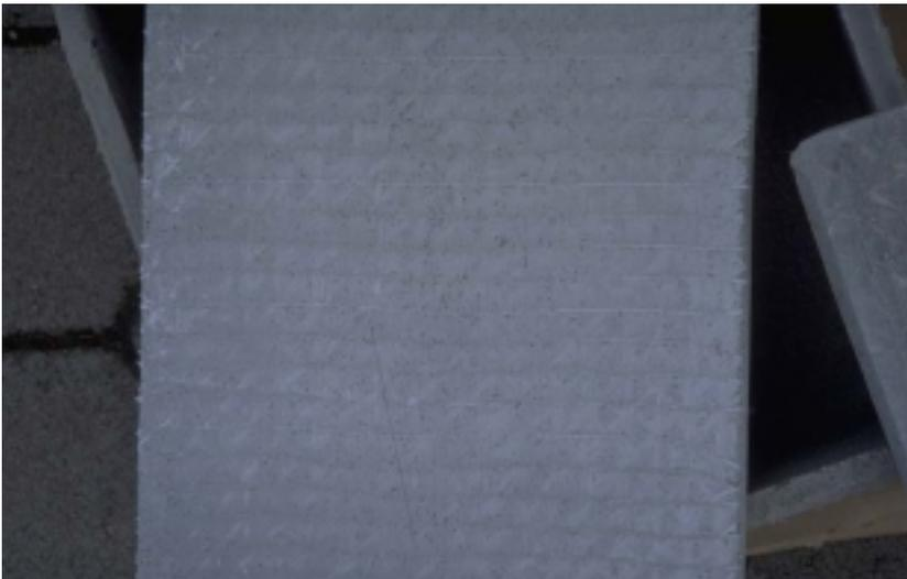
Bild 12: Laminierte textile Bewehrung dank dem Pressverfahren
