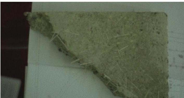
Bild 1: Sprödes Bruchverhalten von mit Kurzfasern bewehrtes Plattenelement
