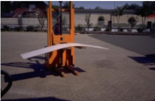
Bild 13: Verformungsverhalten einer dünnen Platte (d=12mm, L=2.50m)
