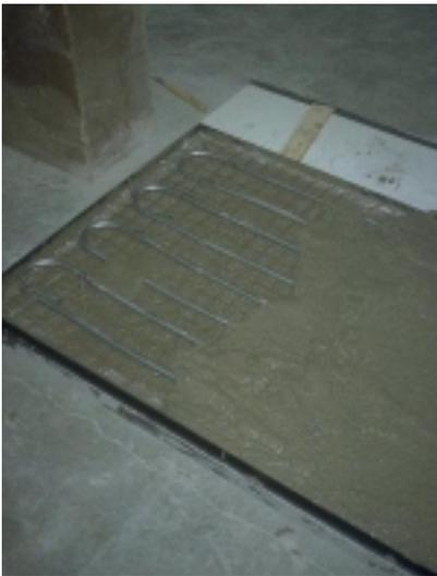
Bild 11: Klimaplatte mit textiler Bewehrung und mittig angeordneten Heizrohren
