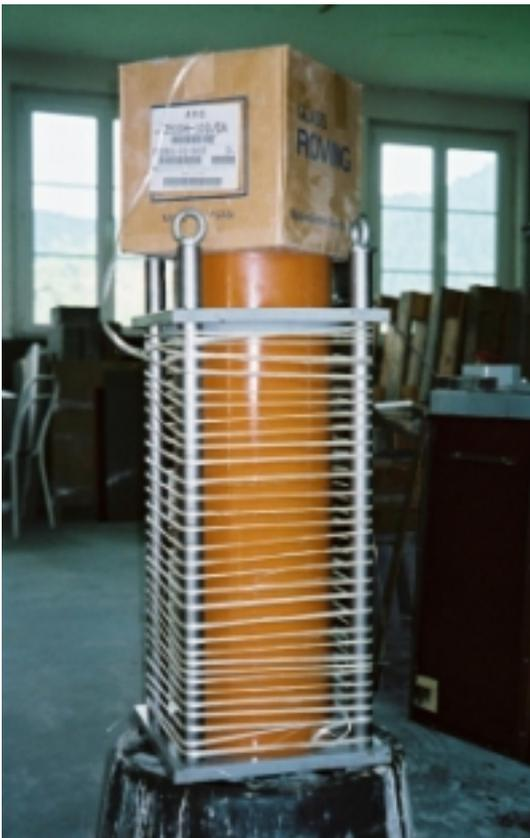
Bild 17: Gestreckte Rovings innerhalb der Hohlkörperschalung
