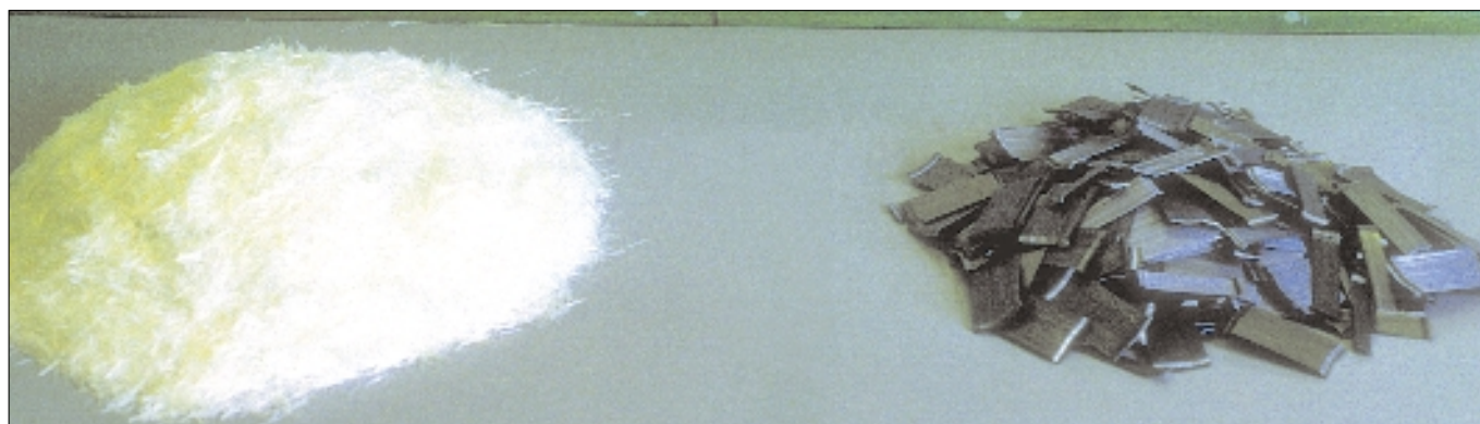
Bild 1: Alkali-resistente Glasfasern und Stahlfasern.
