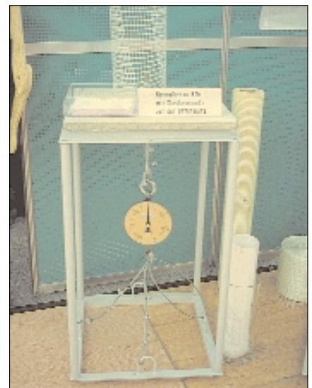
Bild 7: Versuche an Betonplatten mit textiler Bewehrung
