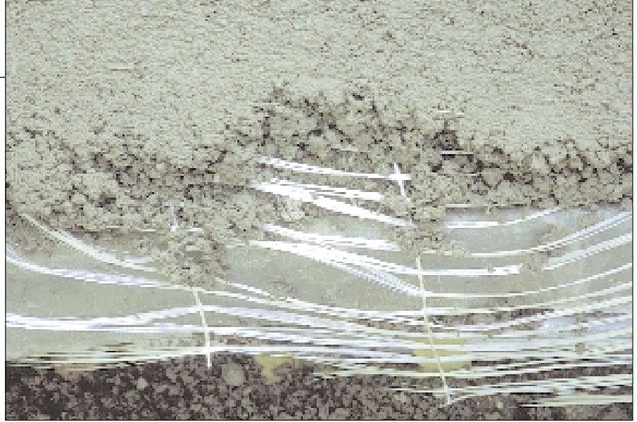
Bild 4: Kombinierte Anwendung von alkaliresistenten Glasfasern als Gelege und Kurzfasern.
