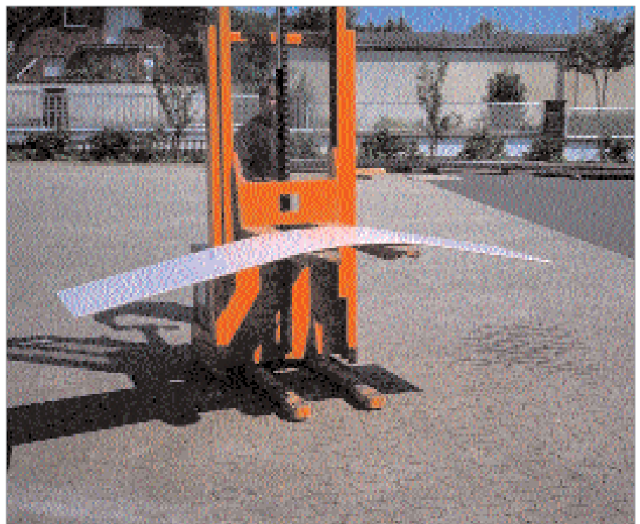
Abb. 18: Duktilen Verhalten einer dünnen textilbewehrten Platte
