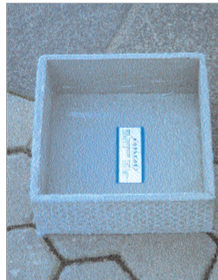
Abb. 14: Multiaxiales Gelege zur Verstärkung eines dünnwandigen Körpers
