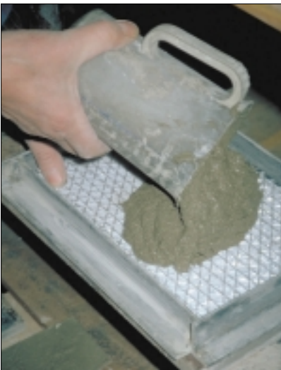
Bild 10: Gießen in zweidimensionale Schalung
