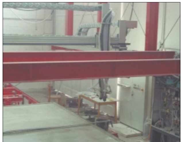
Bild 3: Spritzroboter für Faserbeton im Spritzverfahren
