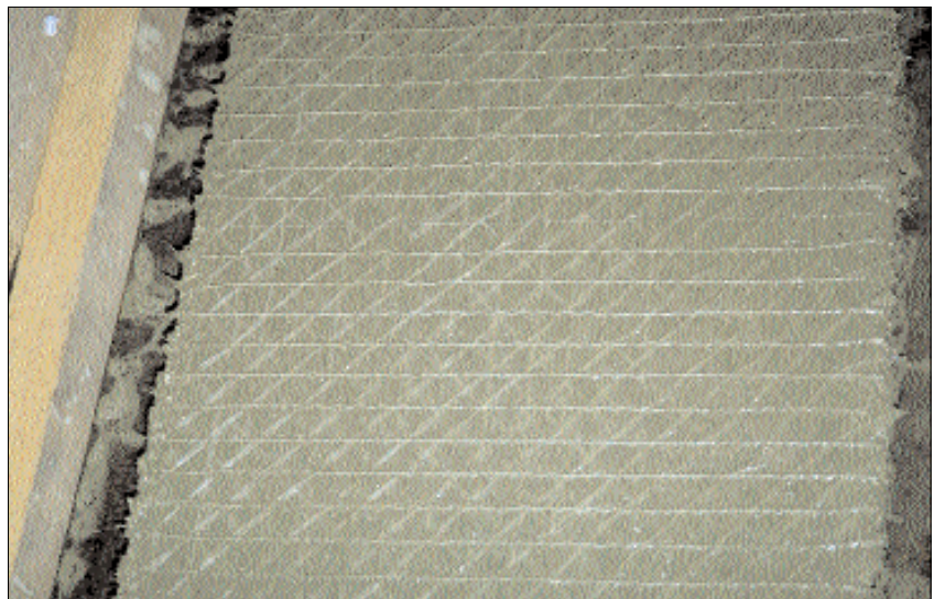
Bild 17: Plattenbauteil mit eingebettetem quadraxialem Glasfasergelege
