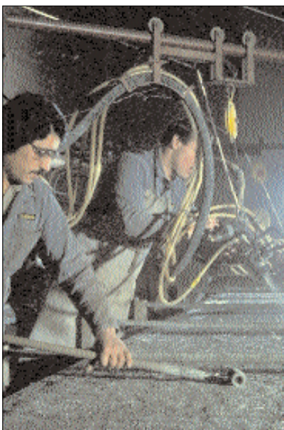
Bild 6: Herstellung und Bearbeitung eines Bauteils aus Glasfaserbeton
