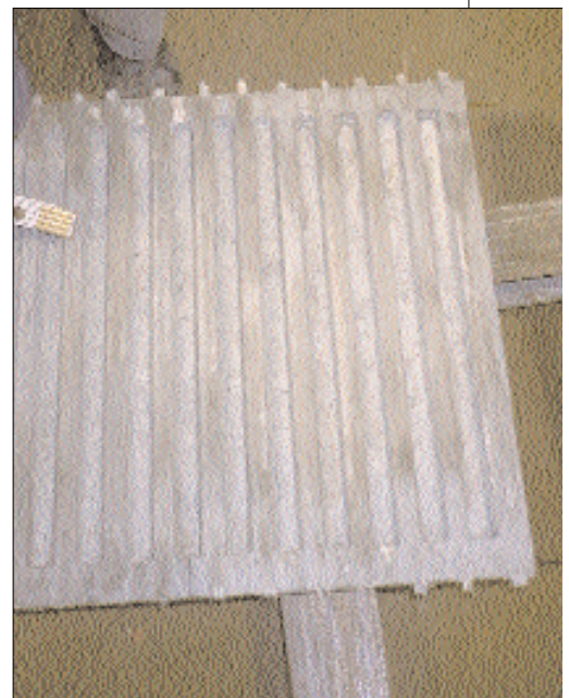
Bild 15: Platte mit Verstärkung der Rippen durch eingebettete Rovings
