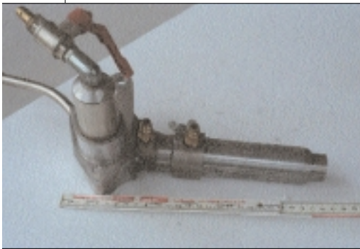
Bild 2: Spritzkopf für Matrix und Glasfasern
