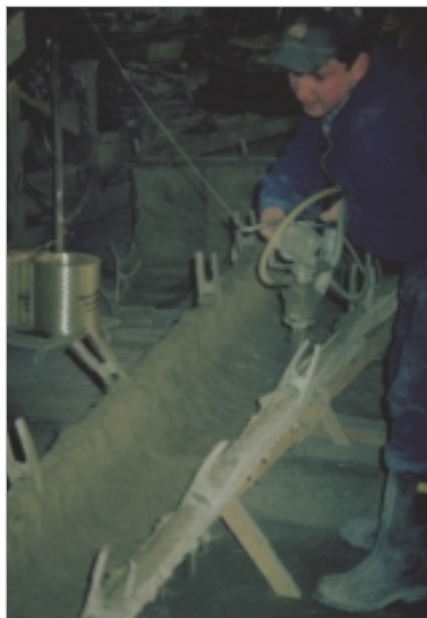
Bild 4: Spritztechnik für aufwendige Geometrie
