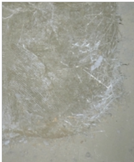
Bild 3: Spritztechnik: hoher Anteil an Glasfasern
