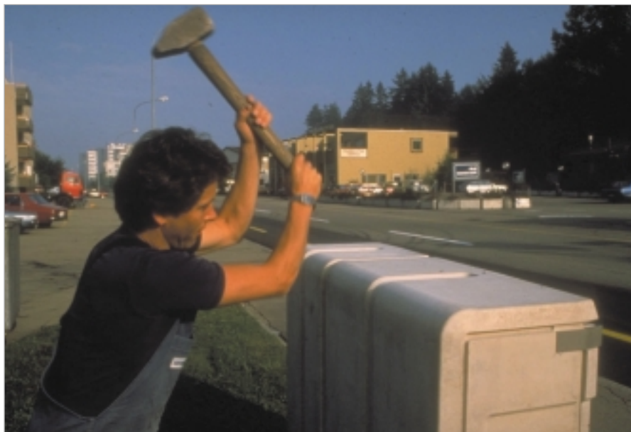
Bild 1: Zäher und duktiler Baustoff Glasfaserbeton
