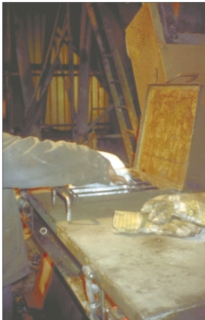
Bild 9: Beimischung der Kurzfasern aus AR-Glas
